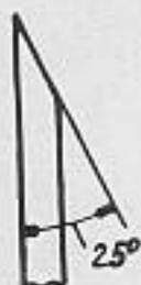
**DER SCHNITT- UND SCHLEIFWINKEL** des Ballens (Wate) beträgt durchschnittlich etwa  $25^\circ$ . Der Ballen soll möglichst gerade sein oder doch nur insoweit hohl, als es der Durchmesser des Schleifsteines oder der Schmirgelscheibe bedingt. Beim Nachschleifen auf dem Rutscher bzw. beim Abziehen entsteht dann von selbst eine kleine Fase an der Schneide, die beim öfteren Nachschleifen in eine gerade Fläche übergeht.
