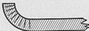
Absperrern von an Flächen anschließenden Rundungen bis 13 cm Halbmesser
