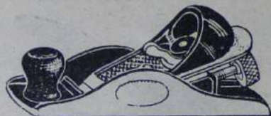
N:o 203. Amerik. Stöthyvel "Stanley", m. järn Av blankslipat och svartlackerat järn. Försedd med fördjupning i sidorna för fingrarna samt ställskruv för reglering av hyveljärnet. Längd 140 mm. Järnets bredd 35 mm.
