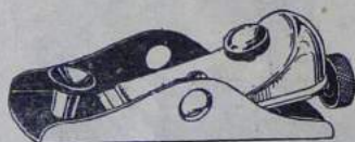
N:o 118. Amerik. Stöthyvel "Stanley", m. järn Helt av stål. Ett "bombsäkert" verktyg. Praktiskt taget oförstörbart. Klaffskruven är stukad och kan ej avlägsnas. Fingerstödet är fastnitat. Fördjupningar i sidorna ger gott grepp. Speciellt avsedd för slöjdsolor. Ställbart järn. Förnicklad och svartlackerad. Längd 150 mm. Järnets bredd 42 mm.
