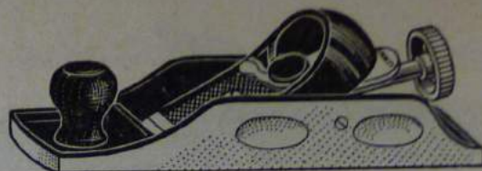
N:o 131. Amerik. Stöthyvel "Stanley", m. järn Av blankslipat och svartlackerat järn. Med fördjupningar i sidorna för fingrarna samt ställskruv för reglering av hyveljärnet. Genom omflyttning av hyveljärn och ställskruv kan järnet placeras i en extra spånöppning som finnes i hyvelns ena ända. Härigenom kan hyvling ske ända fram i hyvelns längdriktning t. ex. in i ett hörn eller dylikt. Längd 200 mm. Järnets bredd 42 mm.
