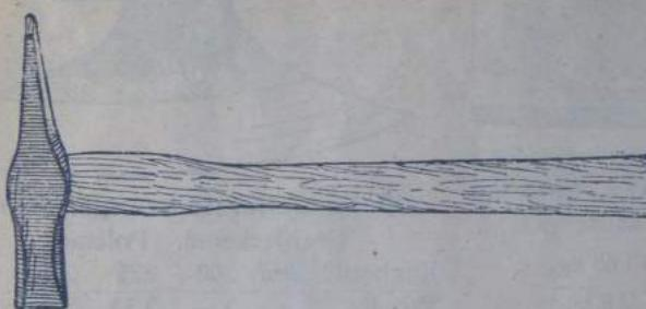
N:o 16. Plåtslagarehammare. (Eskilstuna.) Fyrkantigt slag.
