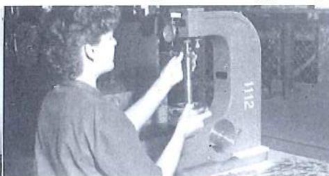
Stämjärnens hårdhet kontrolleras kontinuerligt.
