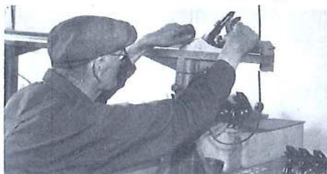
Järnhvelns sula måste vara fullkomligt plan. Ljusrampen avslöjar obarmhärtigt eventuella ojämnheter.
