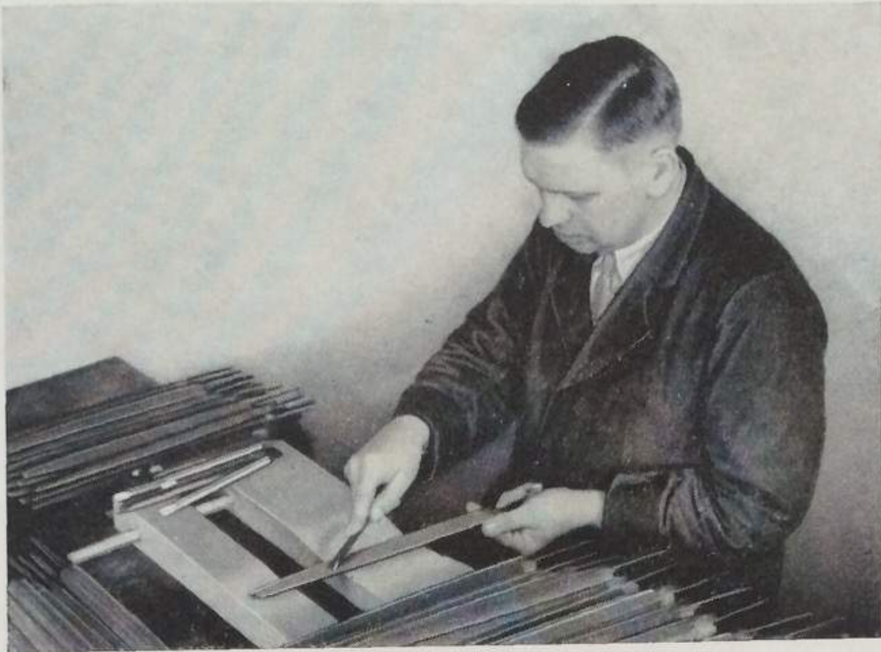
Provning av filar efter härdningen.
