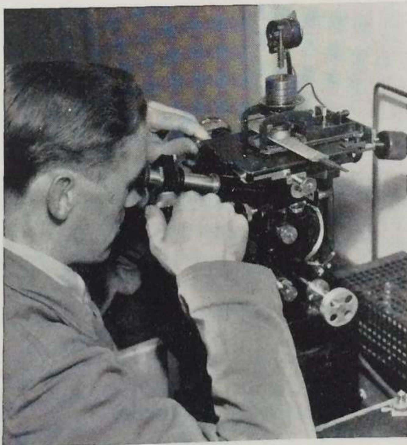
Mikrohårdhetsprovning av filar i laboratoriet.
