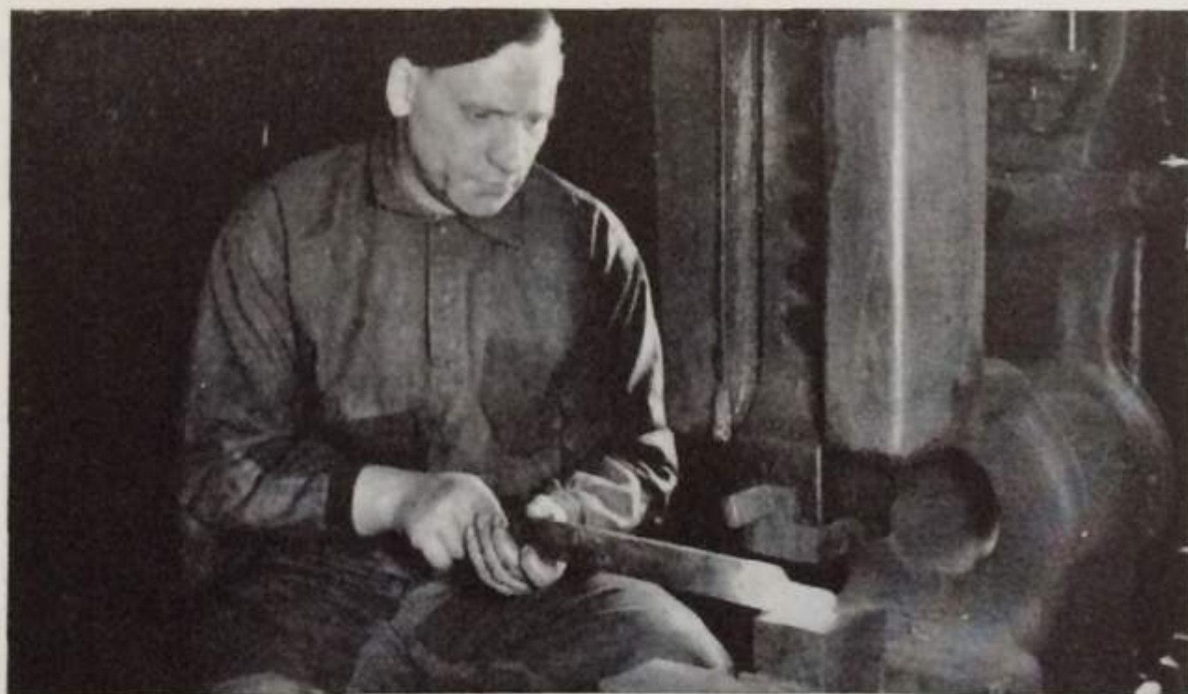
Smidning av filtånge under fjäderhammare.
